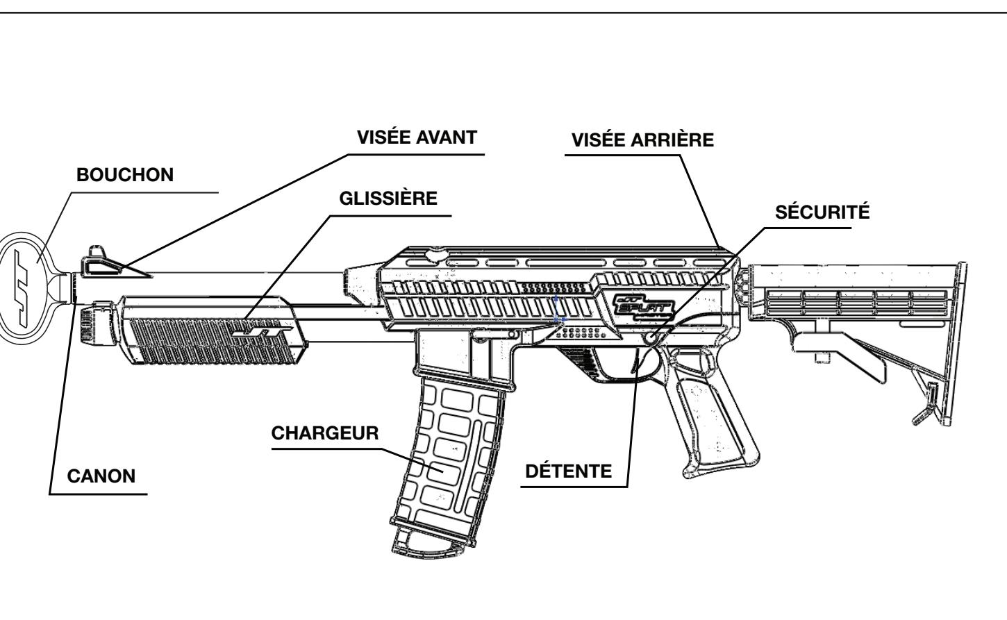
5. Si les étapes 3 et 4 ne nous permettent pas de nettoyer convenablement le canon du Z18, vous pouvez armer la glissière (position arrière/ouverte) et faire couler un peu d'eau dans le canon.
