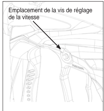
Figure 3: Utilisez une clé hexagonale de 3/16" pour régler la vitesse.
